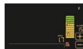
**Localizzatore apicale.** Durante la strumentazione del canale radicolare, la distanza dall'apice è visualizzata sul display LCD. L'approssimarsi all'apice è verificata dal software ENDO. Al raggiungimento dell'apice la rotazione del micromotore è interrotta dalla funzione Apex-Stop.
