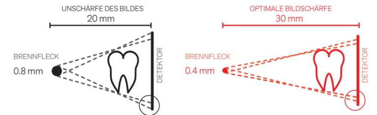
Eine gesteigerte parallele Ausrichtung der Röntgenstrahlen und ein integrierter Kollimator machen es dem RX DC möglich, einen Fokus-Haut-Abstand von 30 cm zu erreichen. Mit RX DC erhalten Sie scharfe, präzise und äußerst detailgenaue Bilder.
